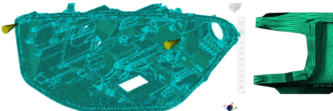
Obr. 28. Ukázka diskretizace (pouzdro A) s detailem vnitřní sítě ve stěně lepící drážky
