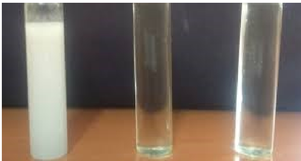
Obrázek 7 Porovnání vzhledu (zleva) emulze, mikroemulze, nanoemulze [50]
