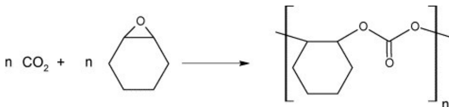
Obrázek 28: Polymerace \text{CO}_2 s cyklohexen oxidem za vzniku PCHC [34]
