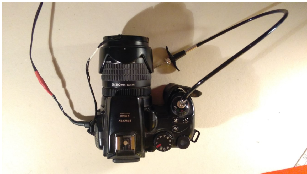
Obrázek 97. Fotoaparát Fujifilm FinePix S9600 s kabelovou spouští.
