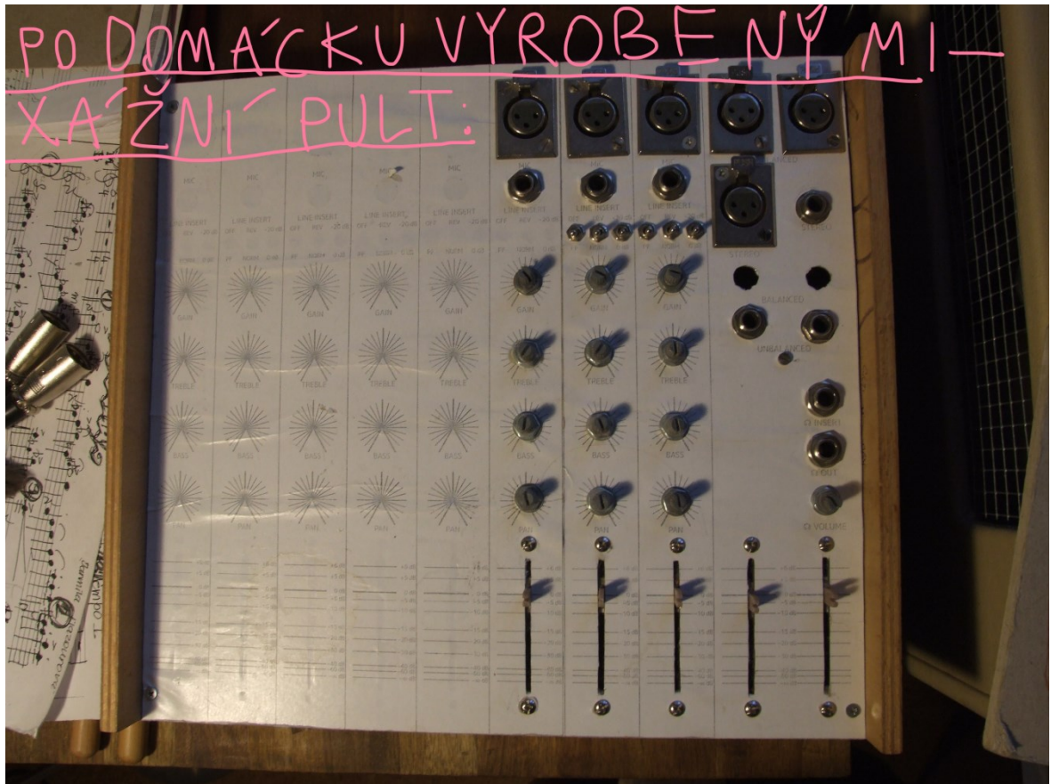
Obrázek 105. Po domácku vyrobený mixážní pult.
