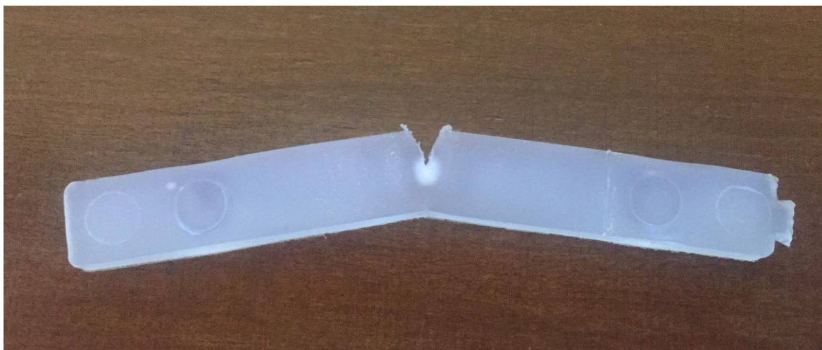
Obr. 20. Šíření trhliny při neúspěšné zkoušce na vzorku PB 8640M
