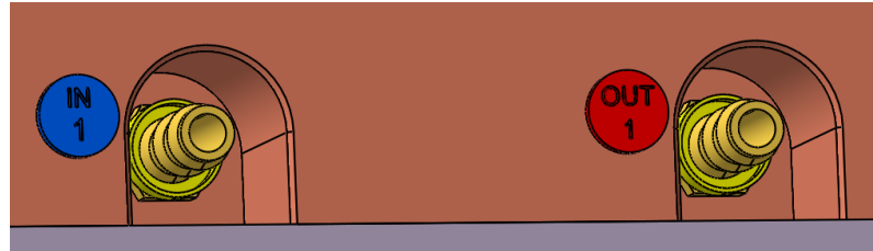
Obr. 34. Rychlospojky s označením temperačních kanálů
