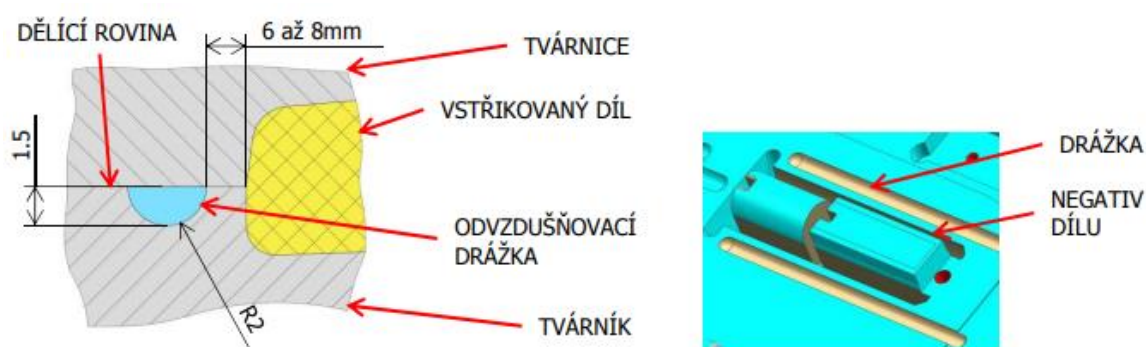
Obr. 21. Příklad odvzdušňovací drážky [31]
