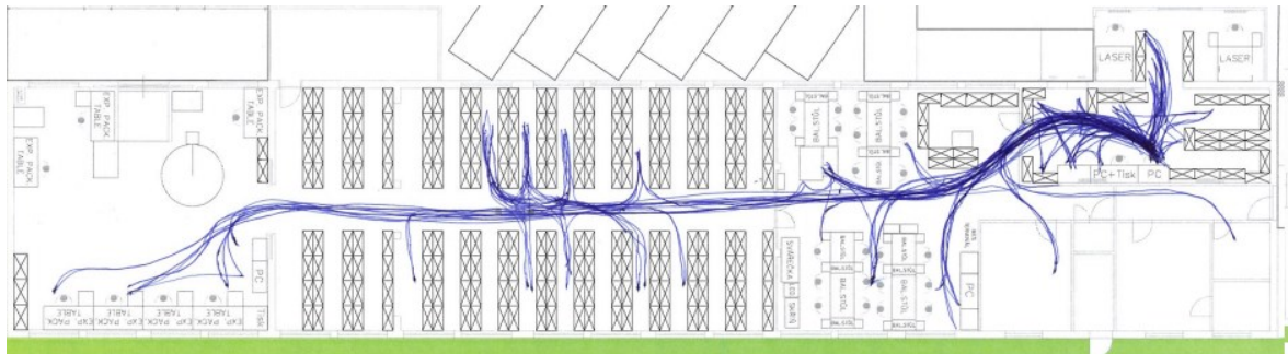
Obrázek 45 Špagetový diagram – pracovnice příjmu součástek (vlastní zpracování na základě firemních podkladů)
