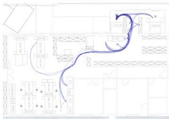
Obrázek 26 Pracovnice laseru – špagetový diagram (vlastní zpracování na základě firemních podkladů)
