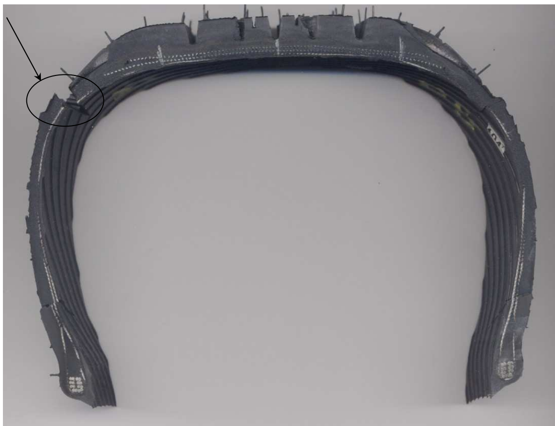
Obr.49. Oblast v profilu pláště pro zjištění velikosti penetrace
