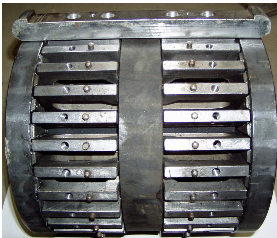
Obr.36. 13" konfekční buben s vyměnitelnými lištami
