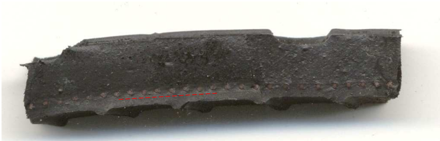
Obr.50. Penetrace vnitřní gumy mezi kordové nitě
