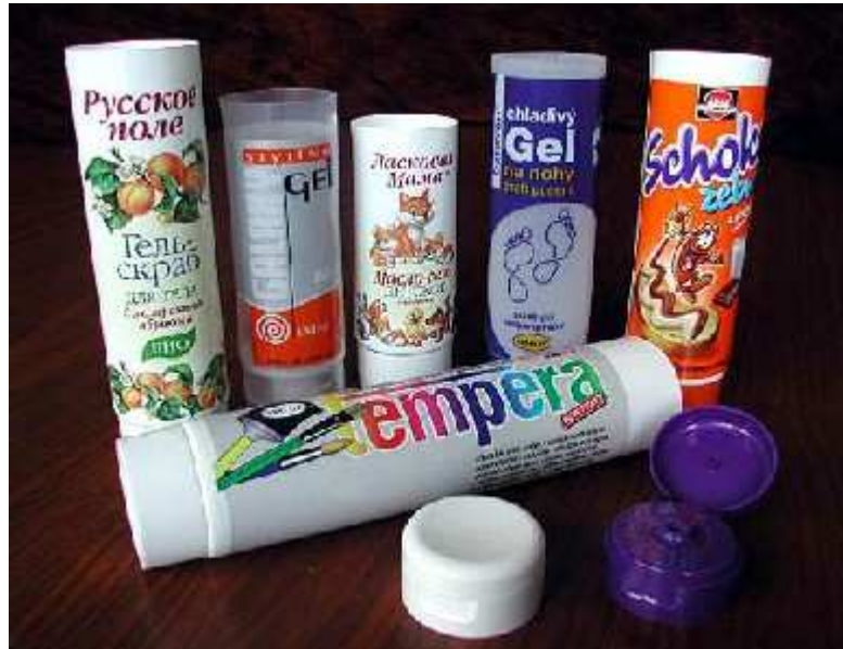
Obr. 12. Typičtí představitelé tub s EVOH bariérou
