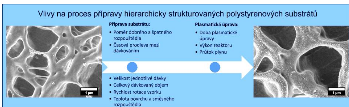
Obrázek 59 - Procesní kroky vedoucí k přípravě hierarchicky strukturovaných PS povrchů vyznačujících se superhydrofóbními vlastnostmi.
