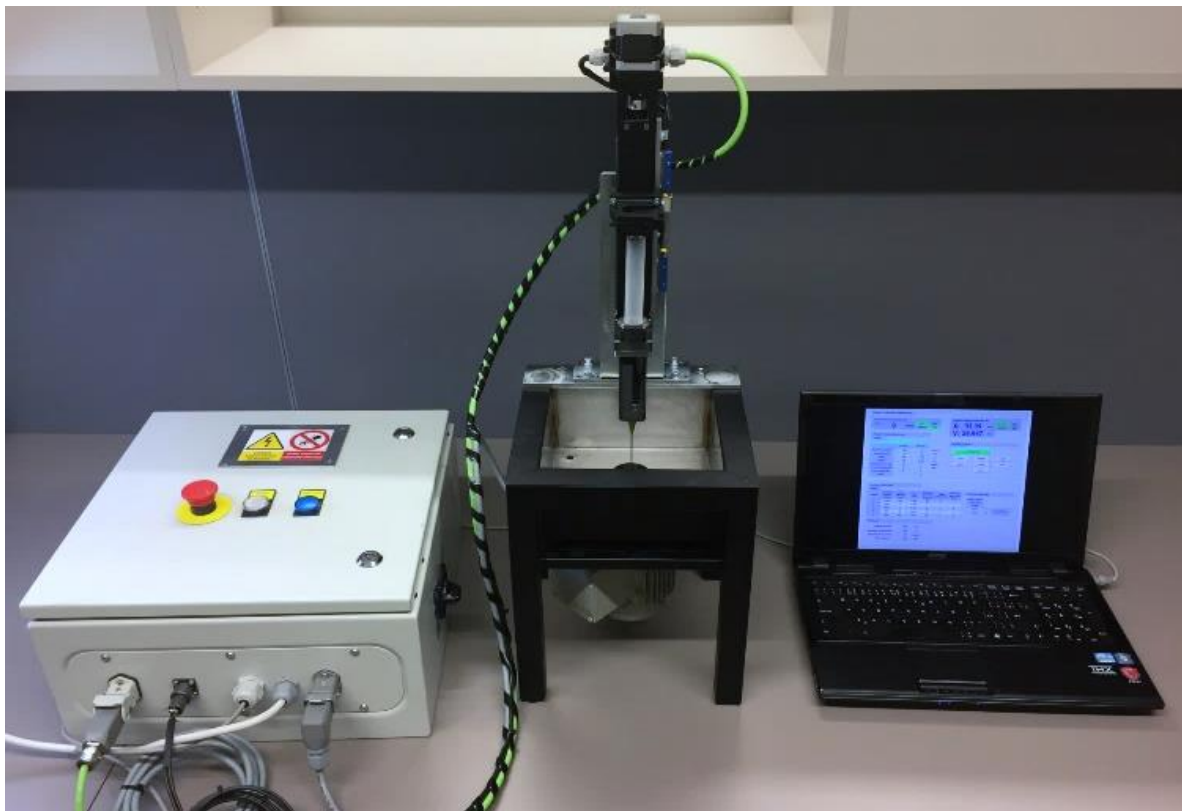
Obrázek 20 - Vyvinuté zařízení pro modifikaci povrchové topografie polymerů (TSSC) skládající se z nosiče vzorku na rotoru, dávkovacího zařízení, řídicí elektroniky a navrženého ovládacího SW.
