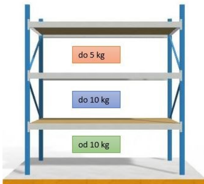
Obrázek 22 – Rozčlenění zboží v regále podle hmotnostní stupnice (jungheinrich.cz; zdroj vlastní)
