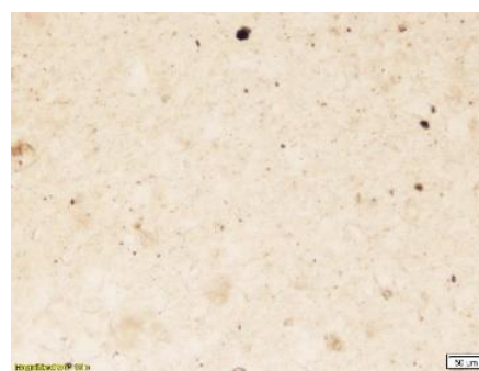
Obrázek 4.8 Fotografie z optické mikroskopie PVP s 2,5% obsahem Zs
