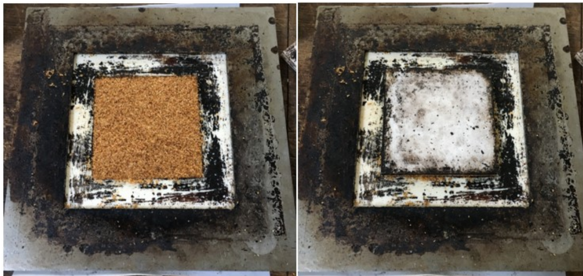
Obrázek 27: Plnění formy směsí (vlevo), vložení kopyta (vpravo)
