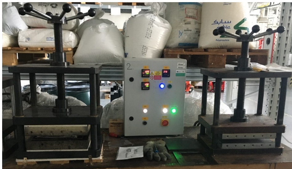
Obrázek 28: Formování tvaru směsi pomocí ručního lisu
