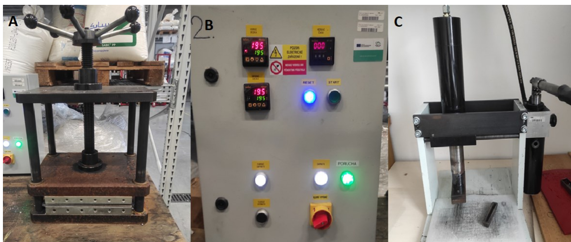
Obrázek 20 Použitý lis (A), nastavení teploty lisu (B), vysekávání tělísek pro tahové zkušební vzorky (C)
