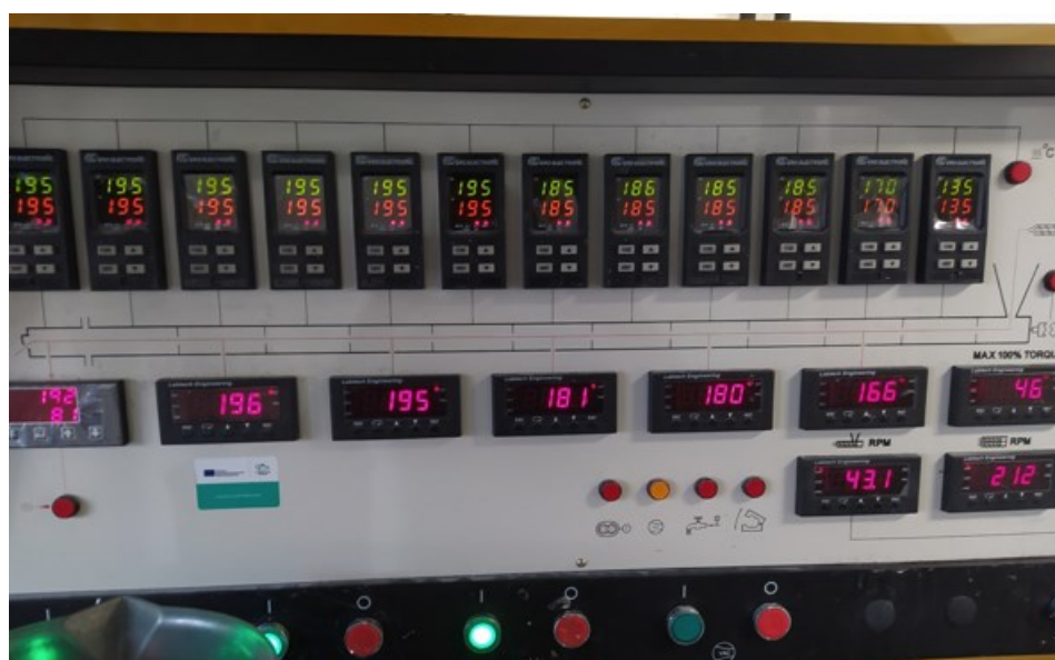
Obrázek 19 Podmínky při kompaundaci PP s expandovatelným grafitem s využitím laboratorního dvoušneku
