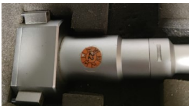
Obrázek 33 – Způsob odkládání měřidla při měření (vlastní zpracování)
