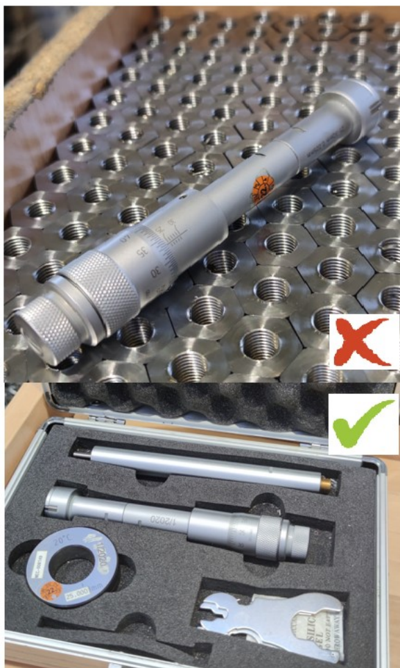
Obrázek 33 – Způsob odkládání měřidla při měření (vlastní zpracování)
