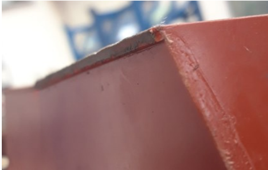
Obr. 9 Nárůstek na okraji odlitku
