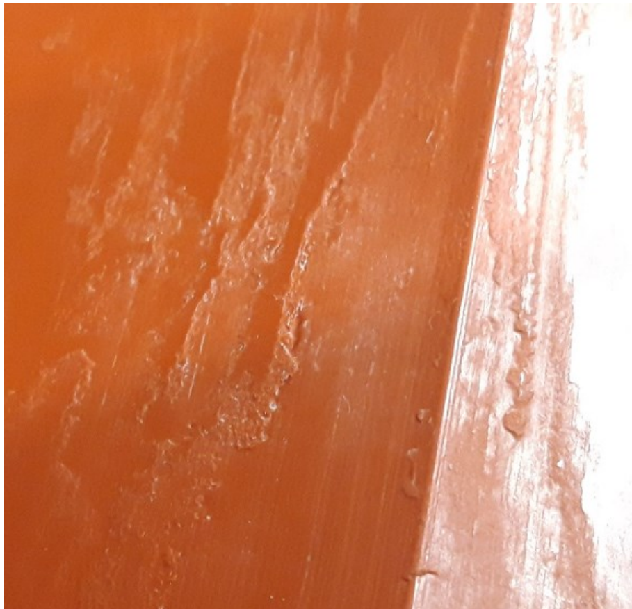
Obr. 10 Drsný povrch odlitku
