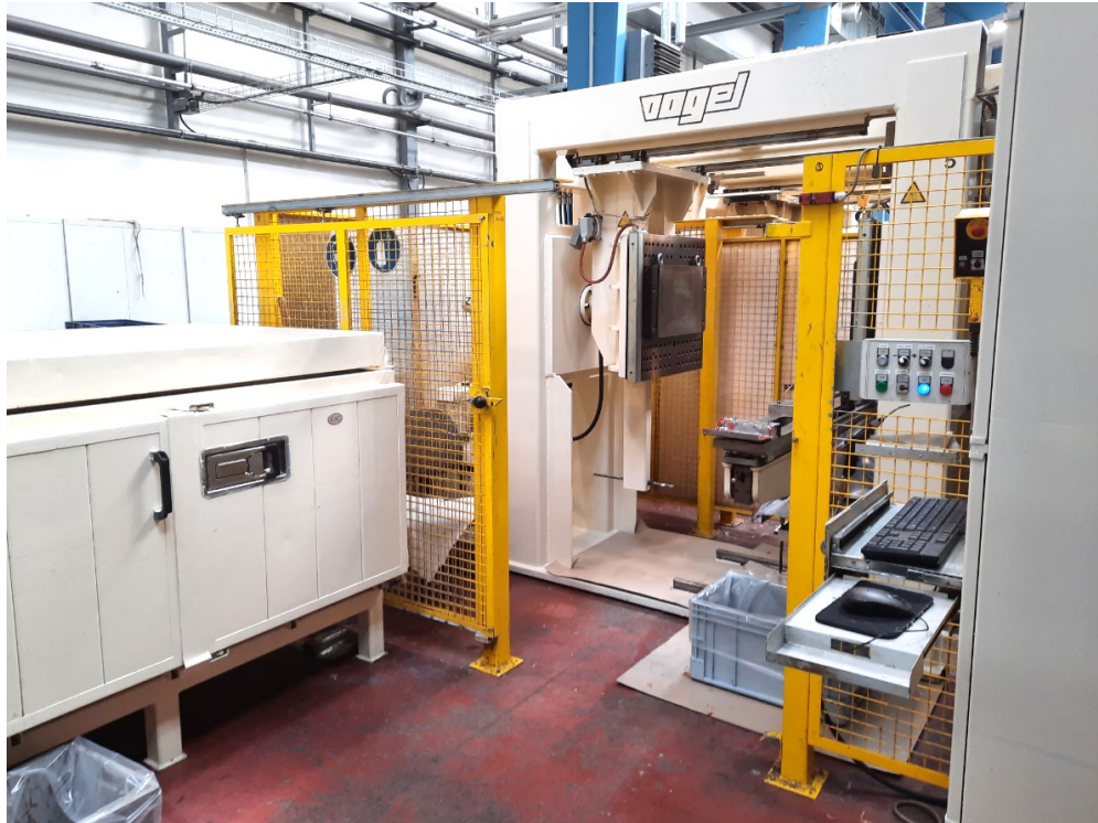
Obr. 7 Lící stroj VOGEL – tlakové lití transformátorů [20]
