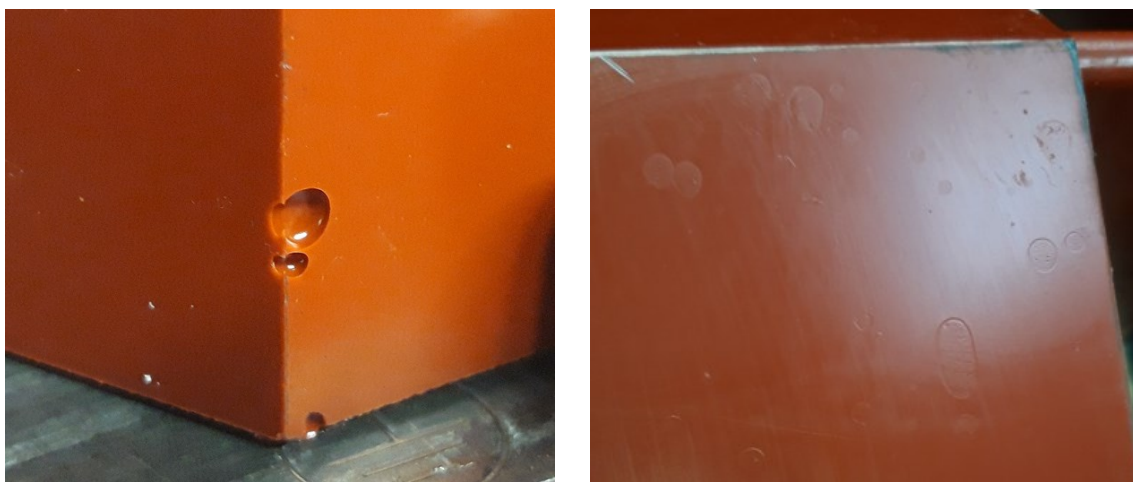
Obr. 16 Vlevo: bublinky na povrchu odlitku, vpravo: opravený povrch odlitku
