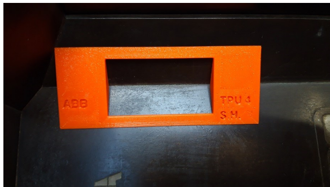
Obr. 21 Pomocný přípravek k zabránění propustnosti světla
