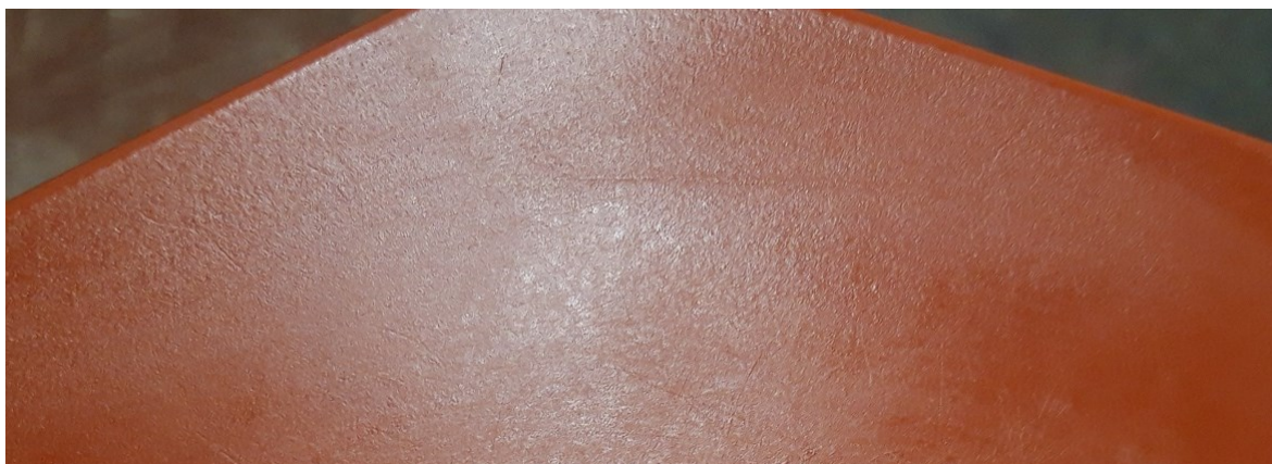
Obr. 11 Obtisknutý napálený povrch formy na odlitku
