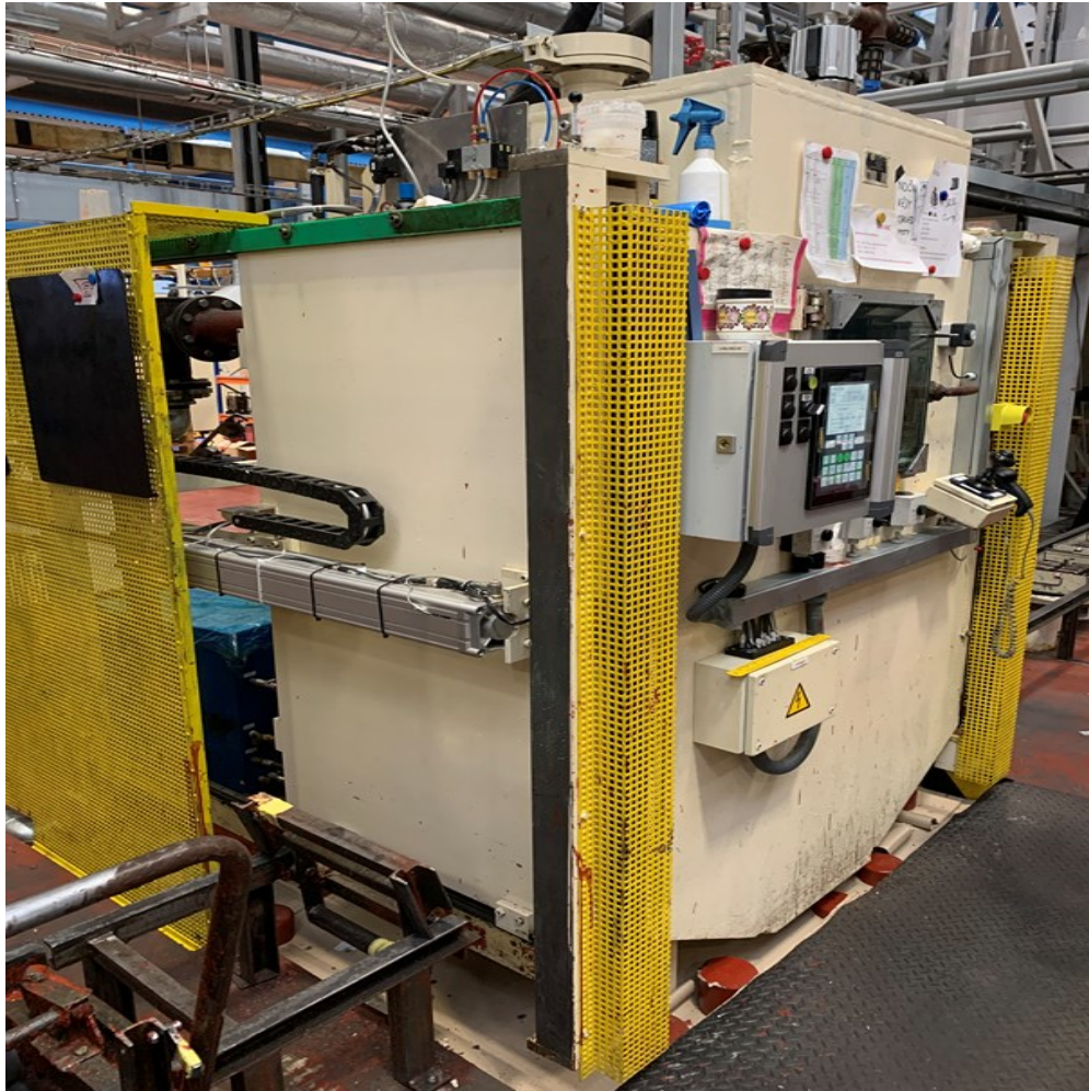
Obr. 8 Vakuová komora (Autokláv) - vakuové lití transformátorů [20]
