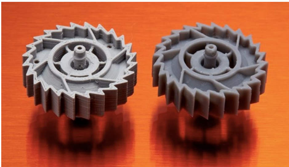
Obr. 17: Porovnání dílu FDM (vlevo) s dílem SLA (vpravo) [20]
