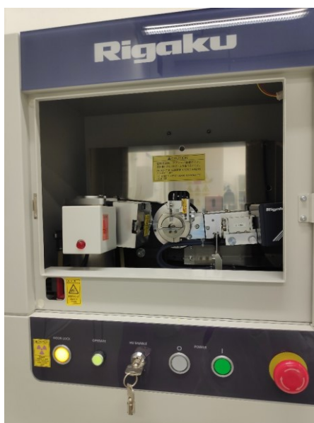
Obrázek 4. Difraktometr Rigaku MiniFlex 600
