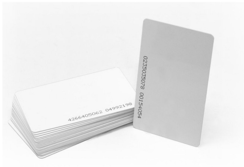
Obrázek č. 18. – RFID Karta TK4100 125 kHz s identifikačním číslem [26]
