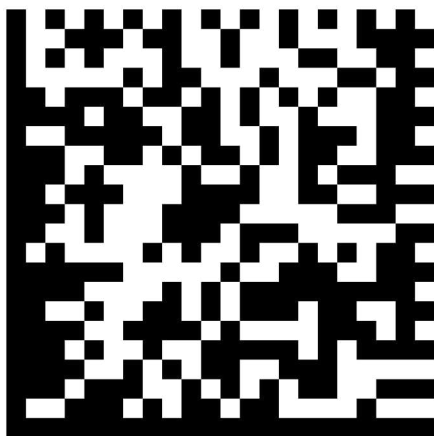
Obrázek 11: Příklad kódu Data Matrix
