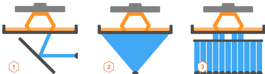
Obrázek 9. Způsoby UV osvitů v SLA tisku [15]
