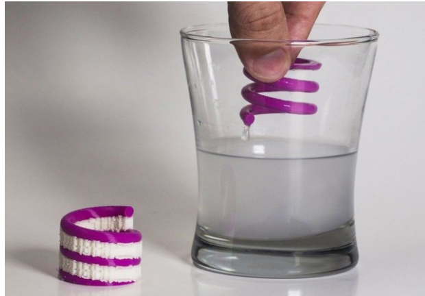
Obrázek 14. Podpěry z materiálu PVA [27]
