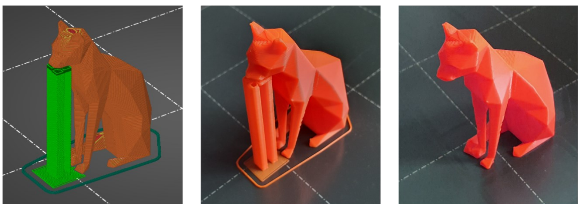
Obrázek 24. (zleva) model s podpěrou, výtisk s podpěrou a po odstranění podpěry
