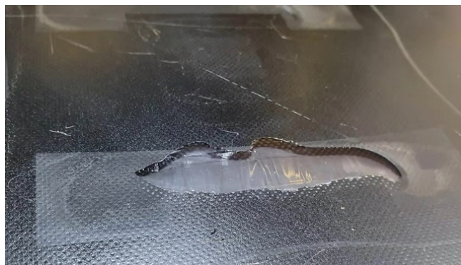
Obrázek 13. Defekt podložky od teplotní deformace PETG [24]
