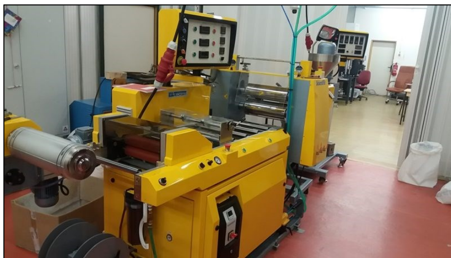
Obrázek 6 Laboratorní linka na vytlačování fólií [44]
