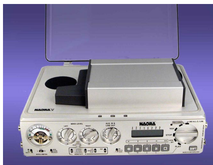
Nagra V - s vyměnitelným hardiskem, nahrává lineárně PCM 24-bit data s nosnou frekvencí 44.1 kHz, 48 kHz (s příslušenstvím 88.2 a 96 kHz) s možností nahrát až 90 hodin záznamu na jeden HD disk. Zvukový formát je ukládán ve vysílacím WAV formátu, zjednodušující postprodukční zpracování. Time code je nahrán standardně ve všech framech.
