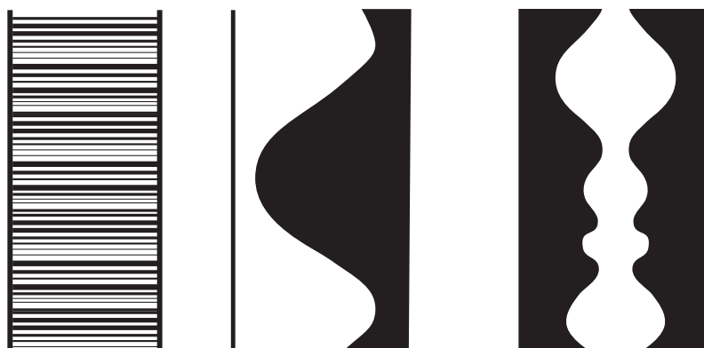
Schéma hustotního a transversálního jednostranného, dvoustranného víceřádkového optického analogového zápisu zvuku.
