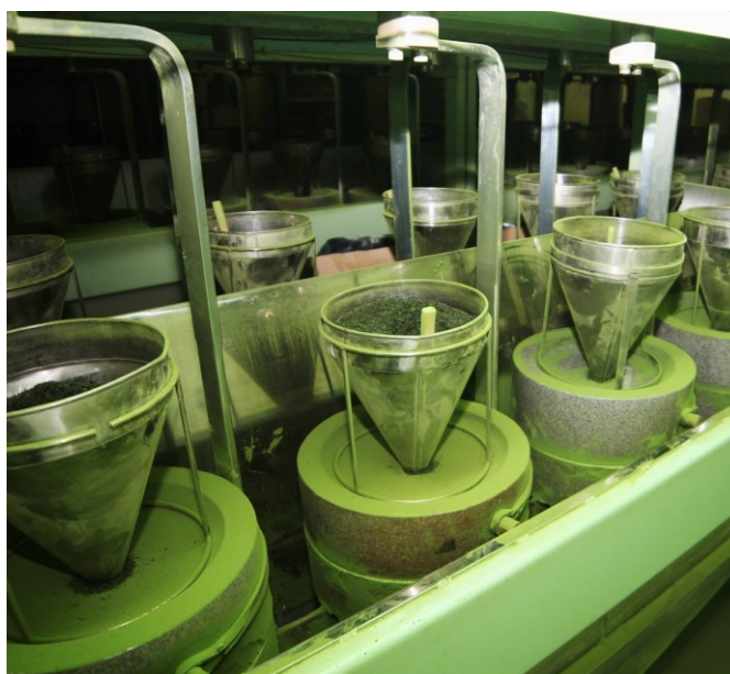
Obrázek 5: Mletí matcha čaje v kamenných mlýncích https://www.matchatea.be/c-5028816/productie-van-matcha-thee/ [103]
