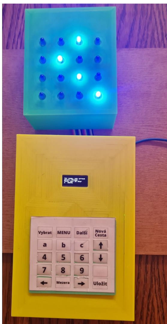
Obrázek 23 LED diody byly přilepeny k boxu s 5 mm otvory, vytisknutém na 3D tiskárně. Katody byly napájeny ke společnému vodiči
