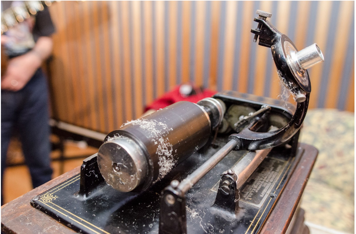
Obrázek 1: Záznam zvuku na voskový váleček
