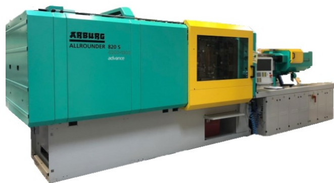
Obrázek 88 Vstřikovací stroj ALLROUNDER 820 S od firmy ARBURG [35]
