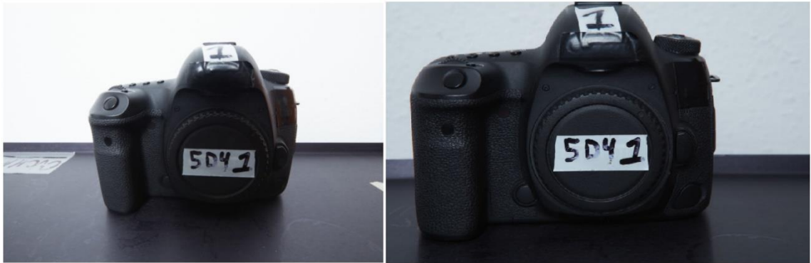
Obrázok 4. Rozdiel v perspektíve vzhľadom na vzdialenosť objektu od kamery [4]
