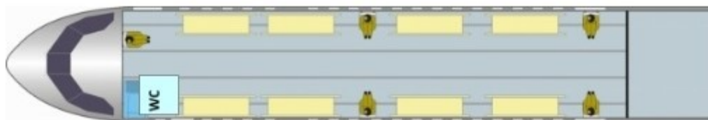
Obrázek 7 Přepravní modifikace letounu CASA C-295M (5 palet 88“x108“) (Grohmann, 2017).
