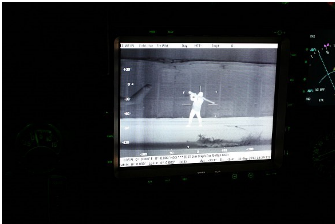
Obrázek 25 Infračervený obraz z FLIR ve vrtulníku Mi-171š (Grohmann, 2013).
