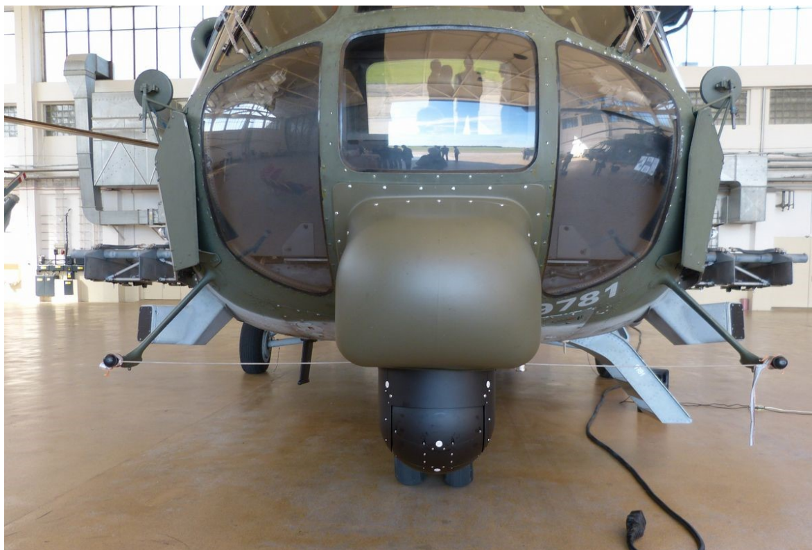
Obrázek 26 Zařízení FLIR a meteorologický radar TWR-850 vrtulníku Mi-171š (Grohmann, 2013).
