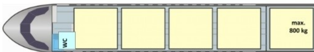
Obrázek 7 Přepravní modifikace letounu CASA C-295M (5 palet 88“x108“) (Grohmann, 2017).
