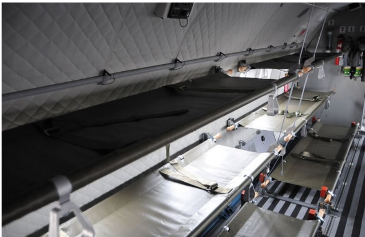
Obrázek 2 Nákladový prostor letounu CASA C-295M sestavený pro přepravu raněných tzv. MEDEVAC (Šindelář, © 2022).
