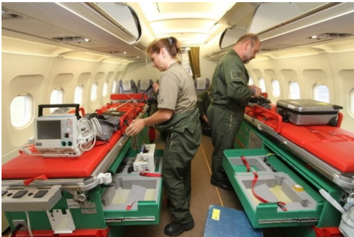
Obrázek 28 jednotka PTU v letounu Airbus A-319CJ (Novák, 2018).
