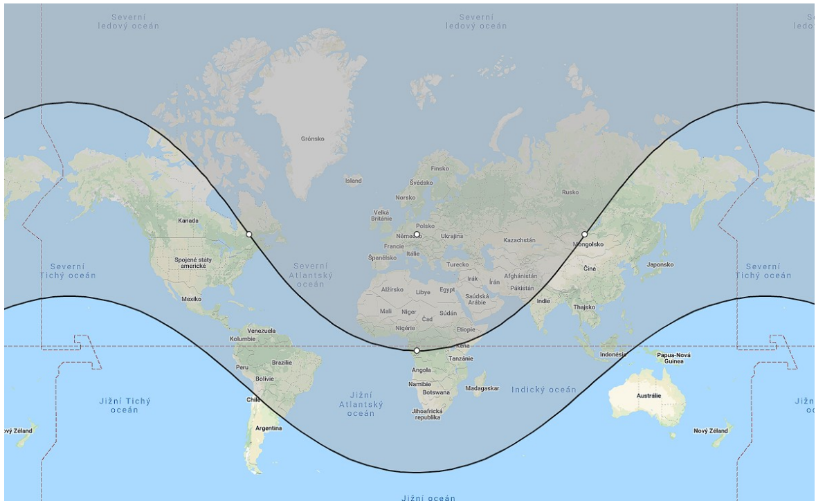
Obrázek 29 Dolet letounu Airbus A-319CJ s přídatnými nádržemi (11 670 km) (Zdroj autor, 2022).
