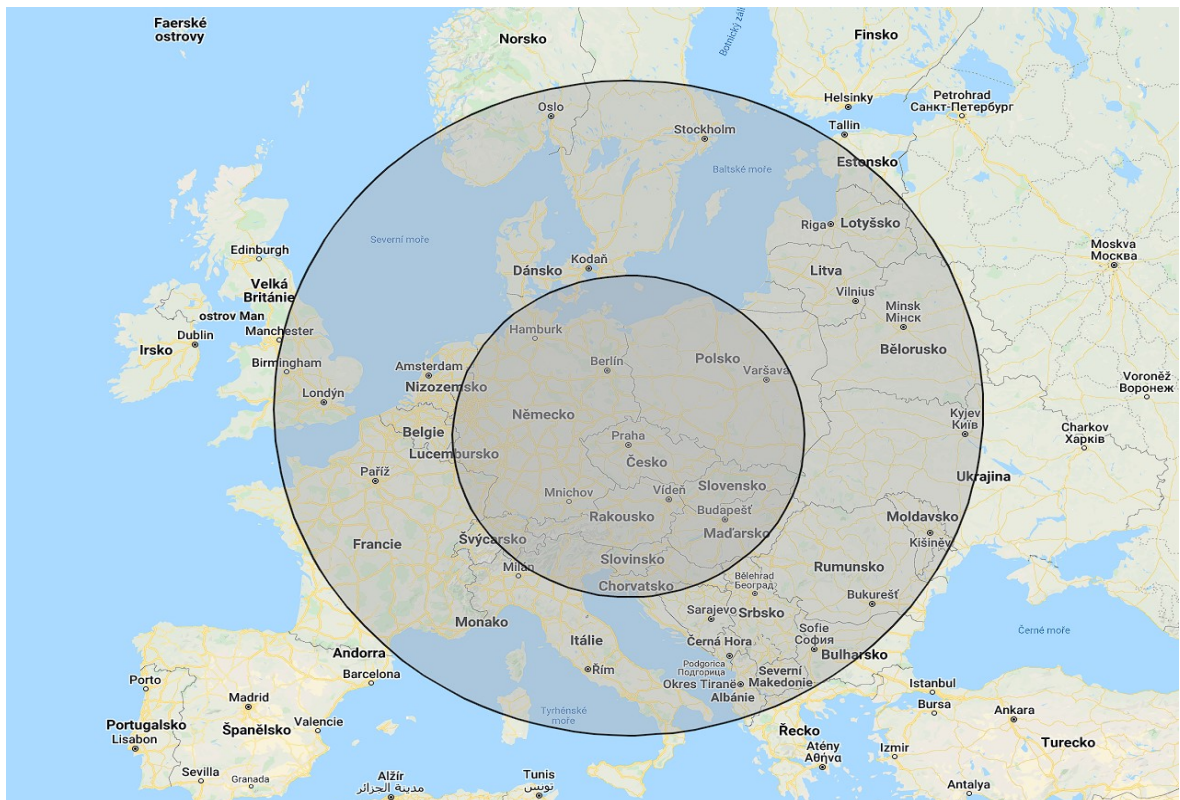
Obrázek 11 Dolet letounu CASA C-295M s maximálním zatížením 9 250 kg (1 200 km) (Zdroj autor, 2022).
