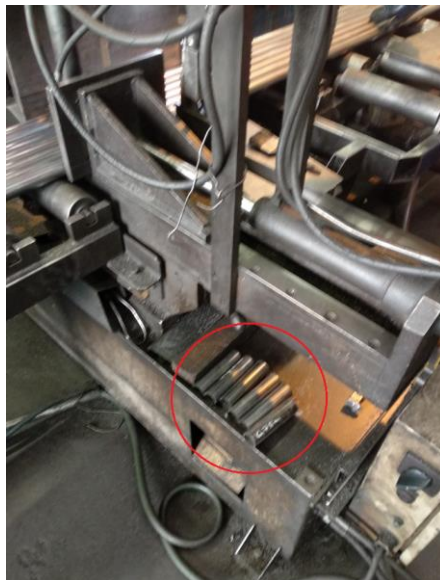
Obrázek 23 – volně položené zbytky materiálu na stroji (vlastní zpracování)
