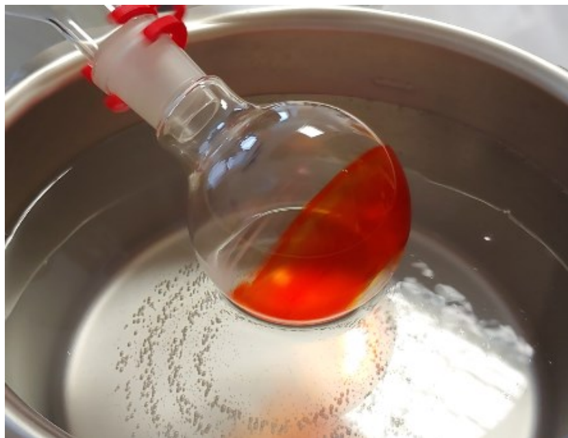
Obr. 7. Odpaření organické fáze a tvorba tenkého filmu
