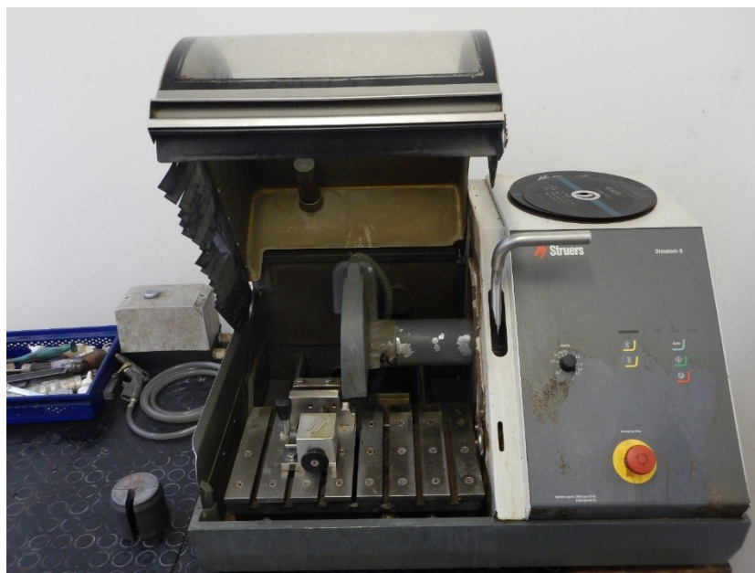
Obrázek 52. Řezání vzorku pilka Stuers – Discotom 6
