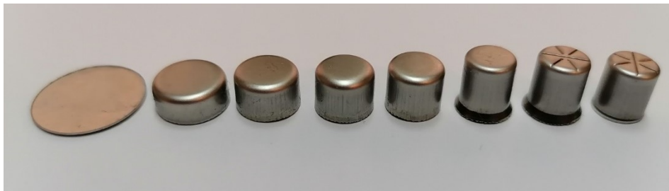
Obrázek 17. jednotlivé fáze výroby kapsle
