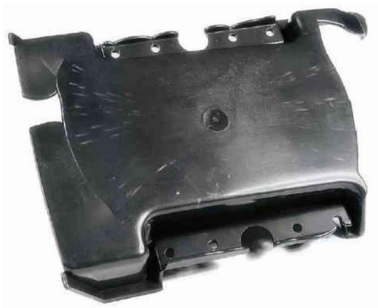
Obr. 12 Ukázka stříbrných pruhů na výrobku [31]
