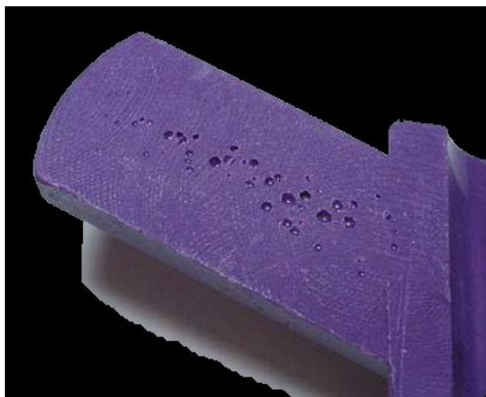
Obr. 13 Příklad vzduchových bublin na výrobku [31]
