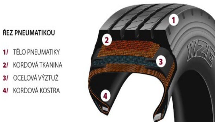
Obrázek 8: Řez pneumatiky (Kordárna Plusa a. s., 2017).
