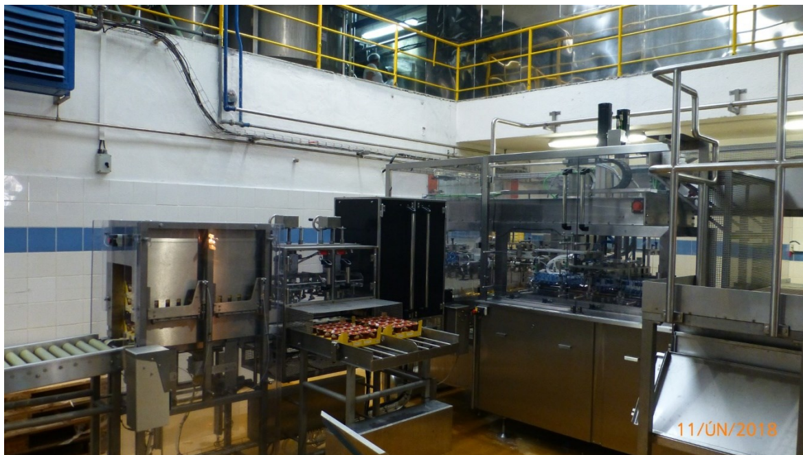
Obrázek 10 – Nové výrobní zařízení (oblast skládání naplněných obalů do kartonů) (Anonym, 2018b)
