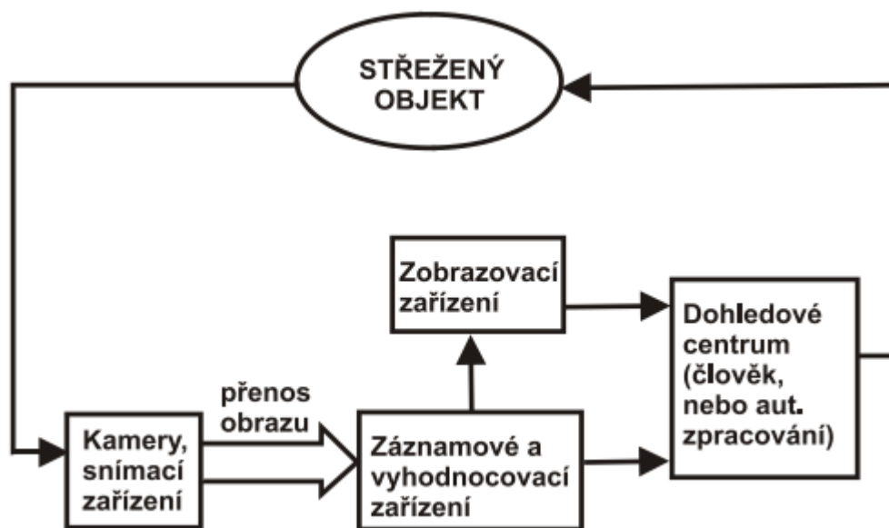
Obrázek 3 Blokové schéma kamerového systému [12]
