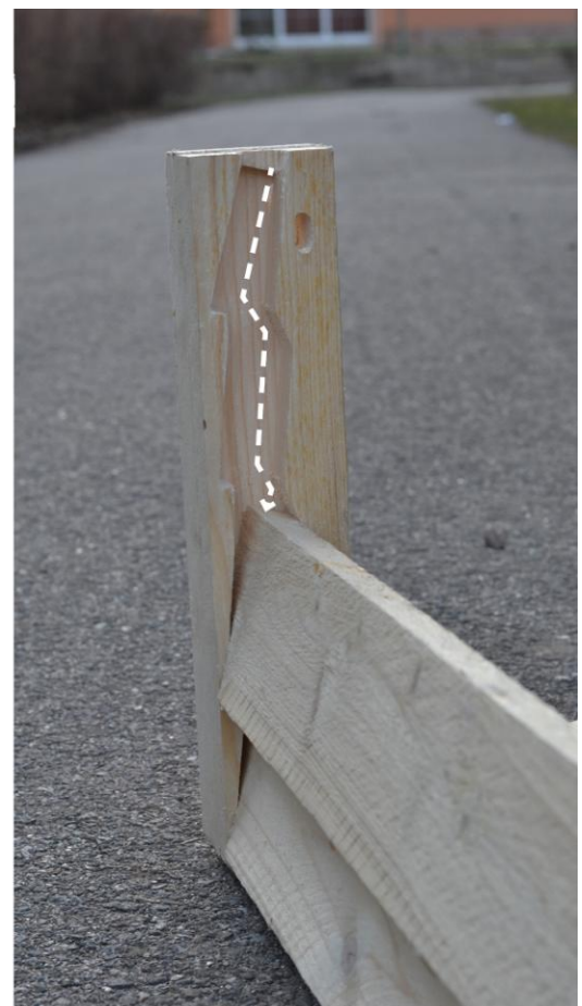
Obrázek 20 – Materiálová zkouška frézované drážky
