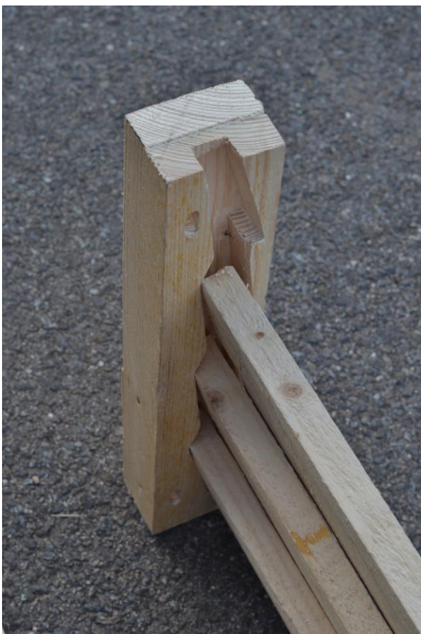
Obrázek 20 – Materiálová zkouška frézované drážky
