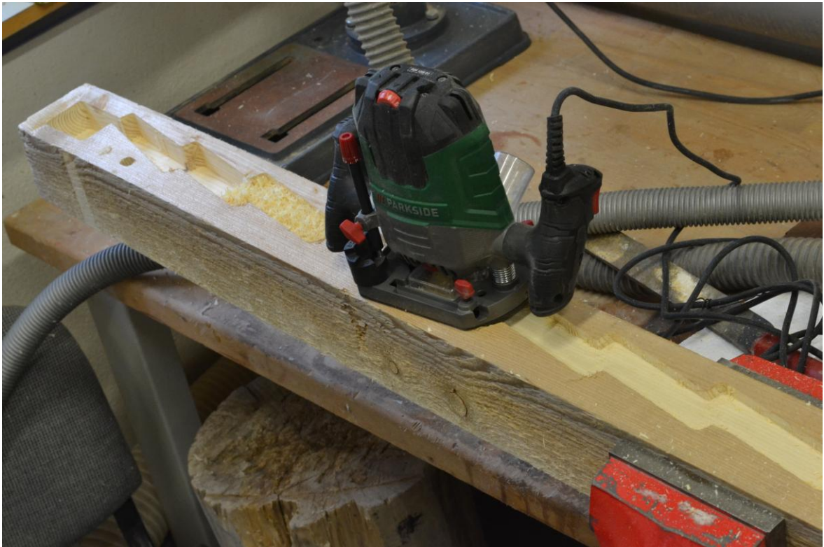
Obrázek 26 – Prohlubování drážky ruční frézou
