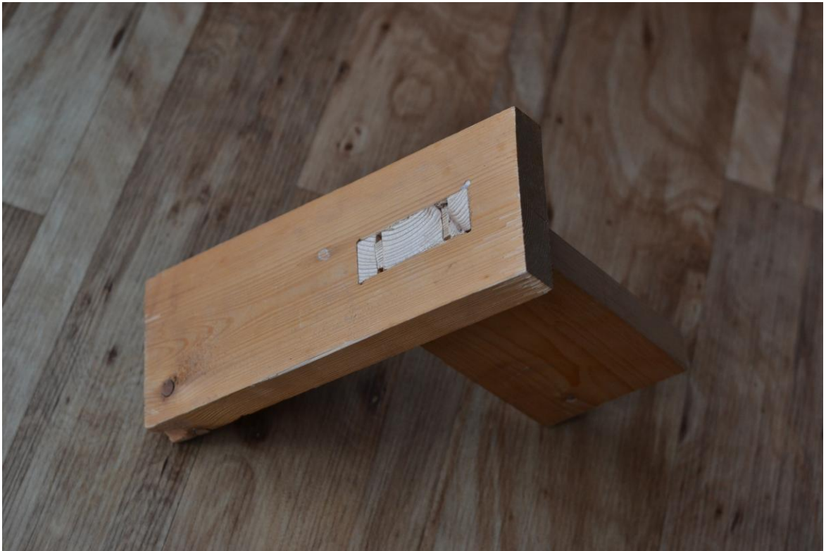
Obrázek 19 – Materiálová zkouška klínového spoje
