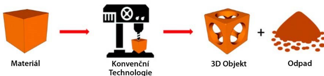
Obrázek 2 Postup výroby při užití konvenční technologie [7]
