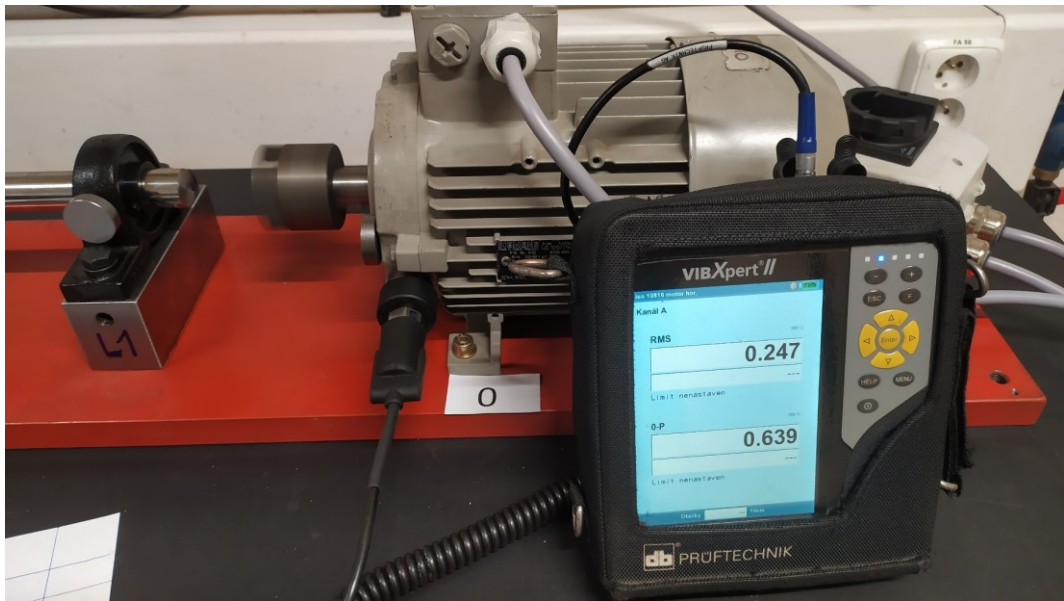
Obrázek 50 Měření celkové hodnoty vibrací samostatného motoru na bodě motor horizontal
