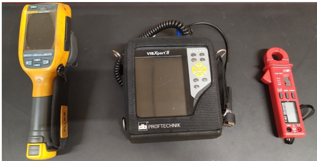
Obrázek 45 Fluke Ti125, Vibxpert II, Benning CM2
