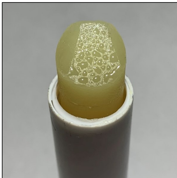
Obrázek 25 Synereze oleje na povrchu vzorku Astrid po provedení experimentu
