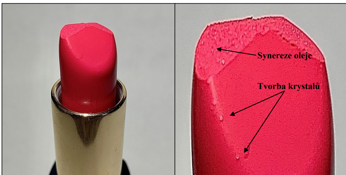
Obrázek 24 Vznik krystalů a synerize oleje na povrchu vzorku Estée Lauder po provedení experimentu
