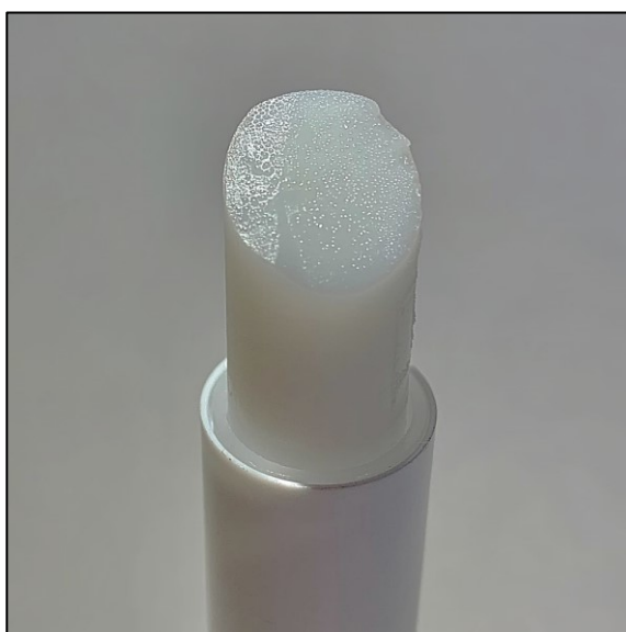
Obrázek 27 Synereze oleje na povrchu vzorku Hi!dea po provedení experimentu
