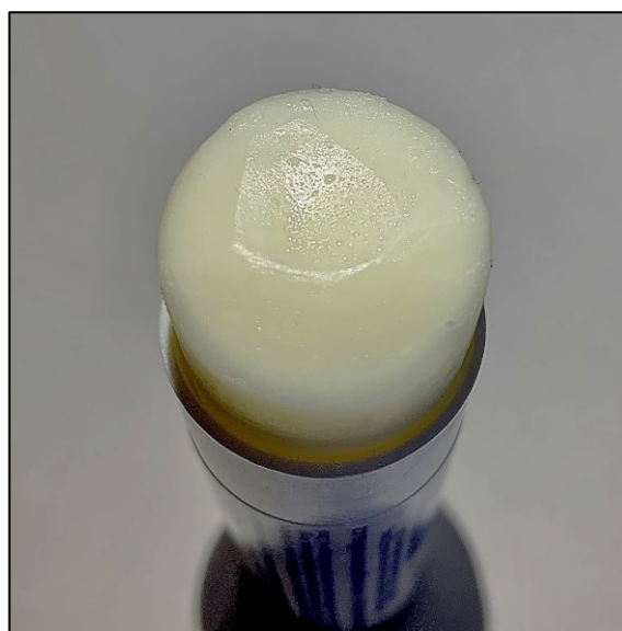
Obrázek 28 Synereze oleje na povrchu vzorku Jelení lůj po provedení experimentu
