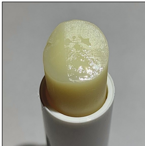
Obrázek 26 Synereze oleje na povrchu vzorku Cien po provedení experimentu
