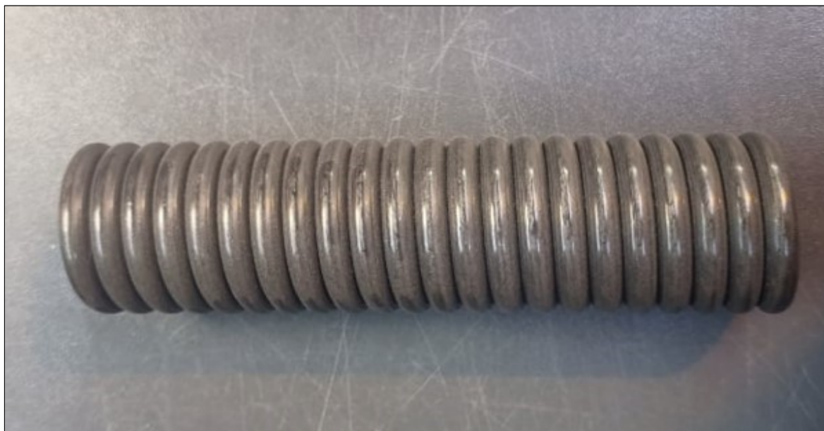
Obrázek 22 Pružina po procesu tváření
