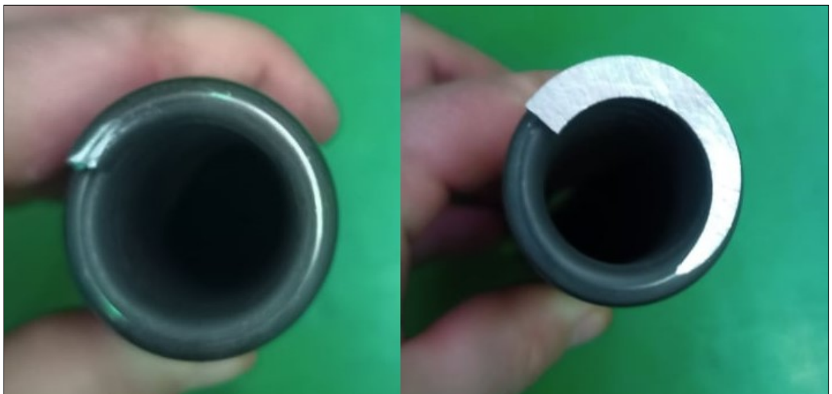
Obrázek 23 Pružina po obroušení
