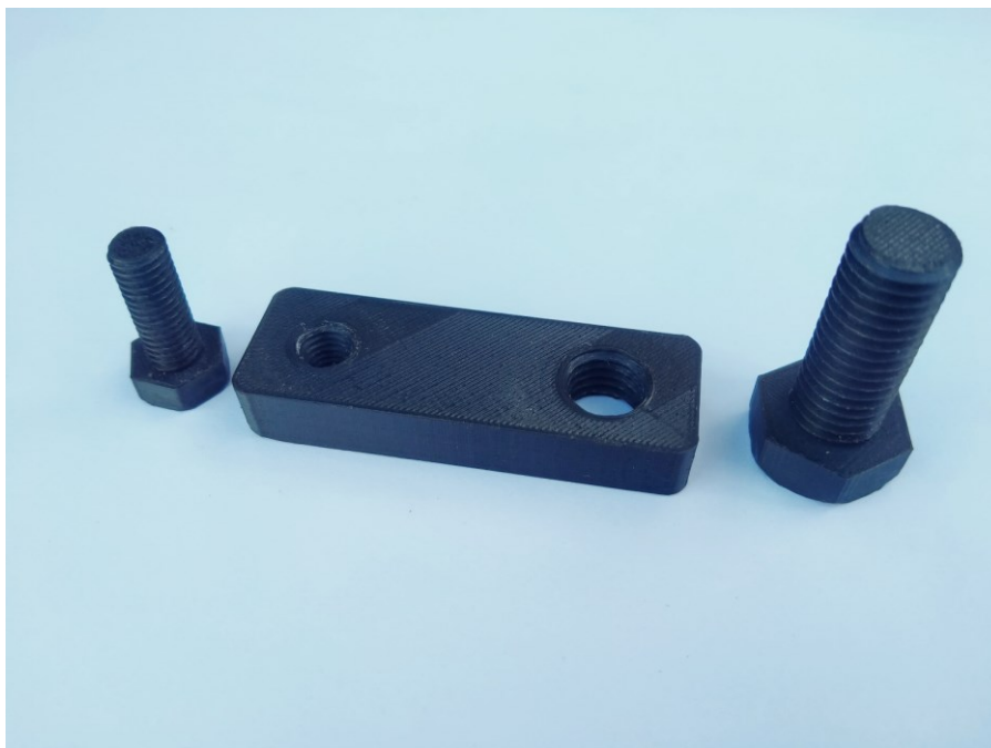
Obrázek 29 Výtisky testovacích těles se závity
