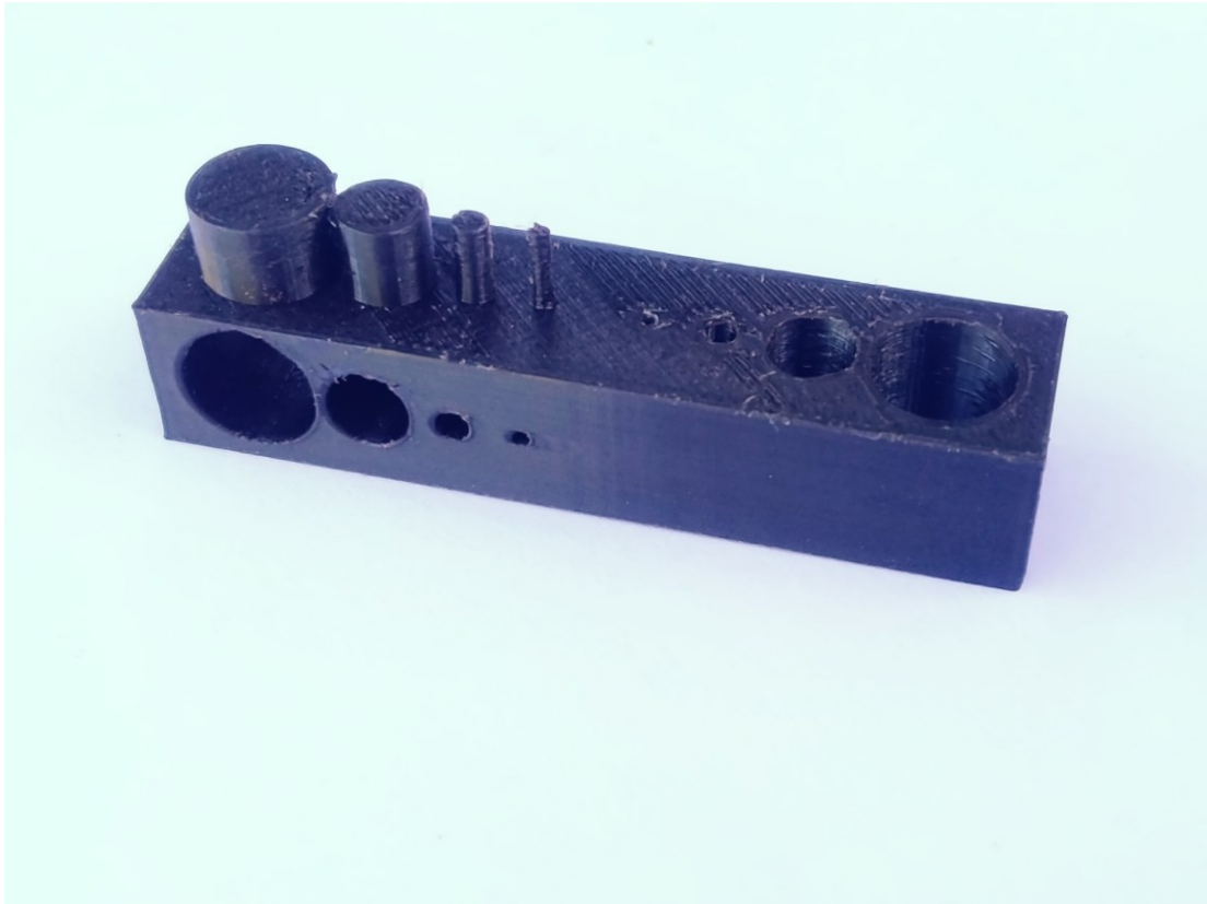
Obrázek 27 Výtisk testovací těleso s válci
