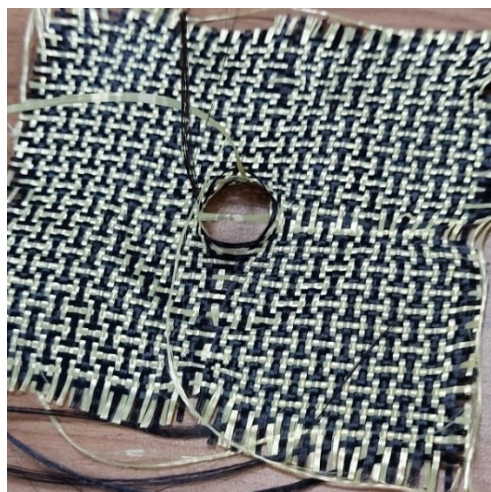
Obrázek 38. Aramid-diolenová tkanina po zkoušce [vlastní tvorba]
