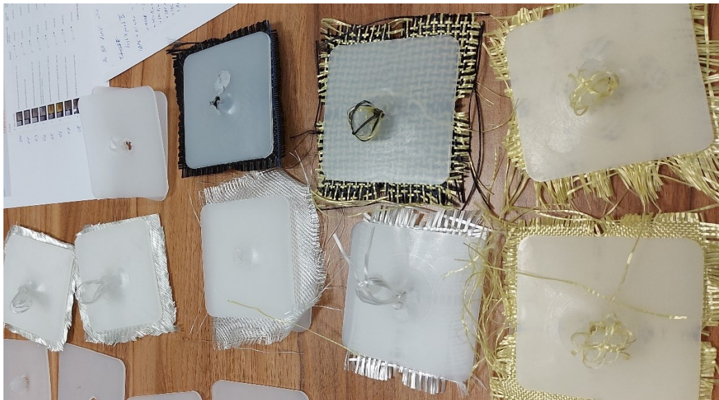
Obrázek 57. Proražené sendvičové vzorky [vlastní tvorba]
