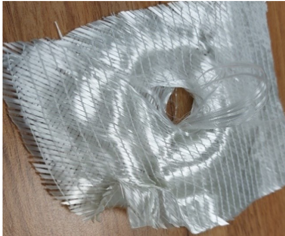
Obrázek 36. Biaxiální tkanina po zkoušce [vlastní tvorba]
