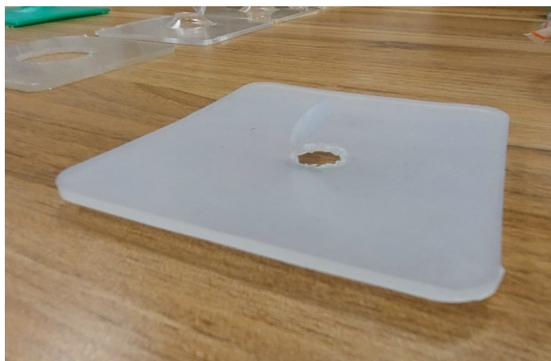
Obrázek 47. LDPE deska po zkoušce [vlastní tvorba]
