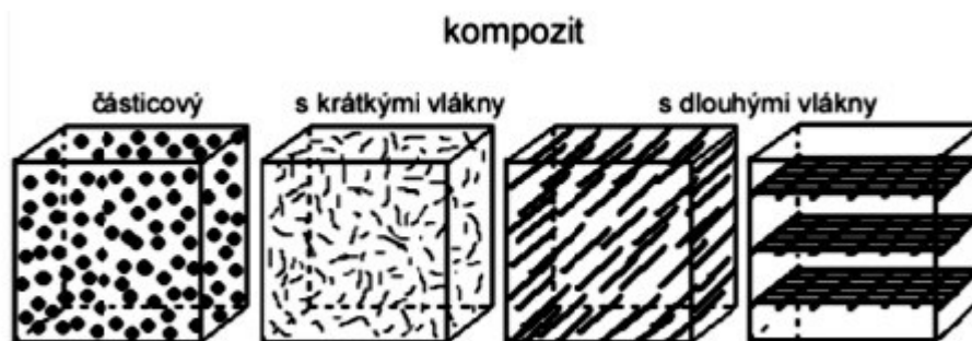
Obrázek 8. Tvary výztuže kompozitu [2]
