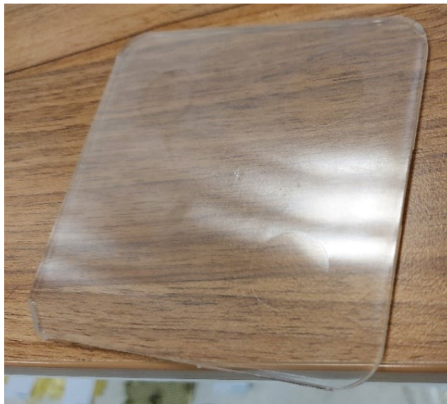
Obrázek 44. PC deska před zkouškou [vlastní tvorba]
