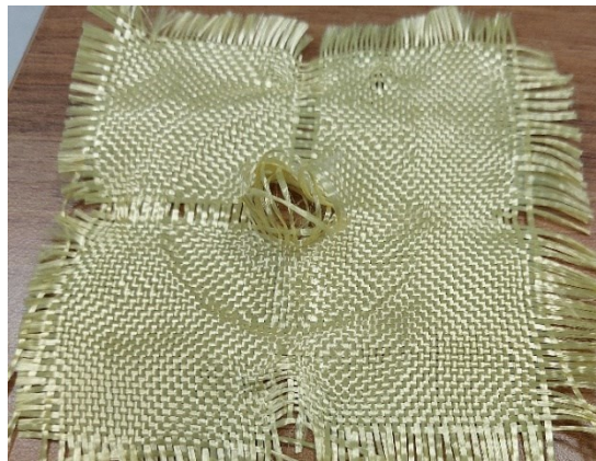
Obrázek 37. Aramidová tkanina po zkoušce [vlastní tvorba]
