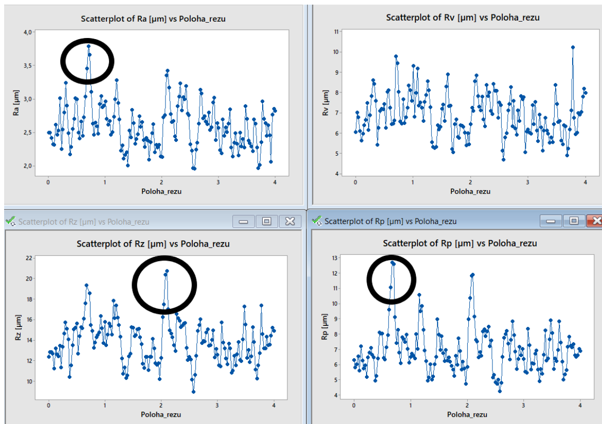
Obrázek 37 – závislost parametrů Ra, Rz, Rv, Rp vzorku Q2 na poloze
