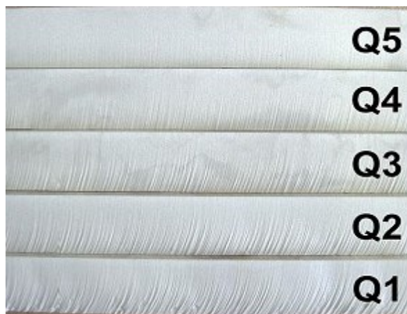
Obrázek 7 – Kvalita povrchu při rozdílných řezných podmínkách [14]
