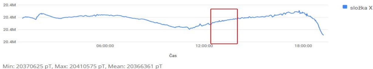
Obrázek 55: Měření intenzity magnetického pole Země – observatoř Budkov 26. 3. 2022 (12:15 – 14:20). [90]
