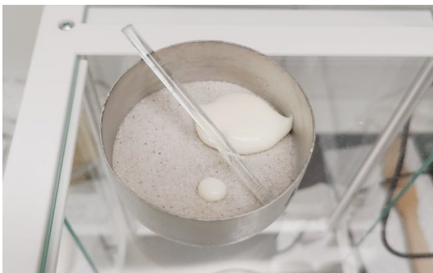
Obrázek 8: Vysoušecí miska s křemenným pískem, skleněnou tyčinkou a vzorkem taveného sýru připravená na analýzu celkové sušiny (Šantová, 2022)
