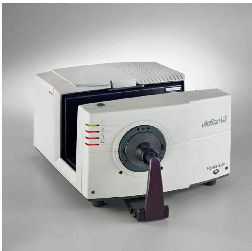
Obrázek 15: Použitý spektrofotometr HunterLab UltraScan® VIS pro instrumentální měření barvy (6)
