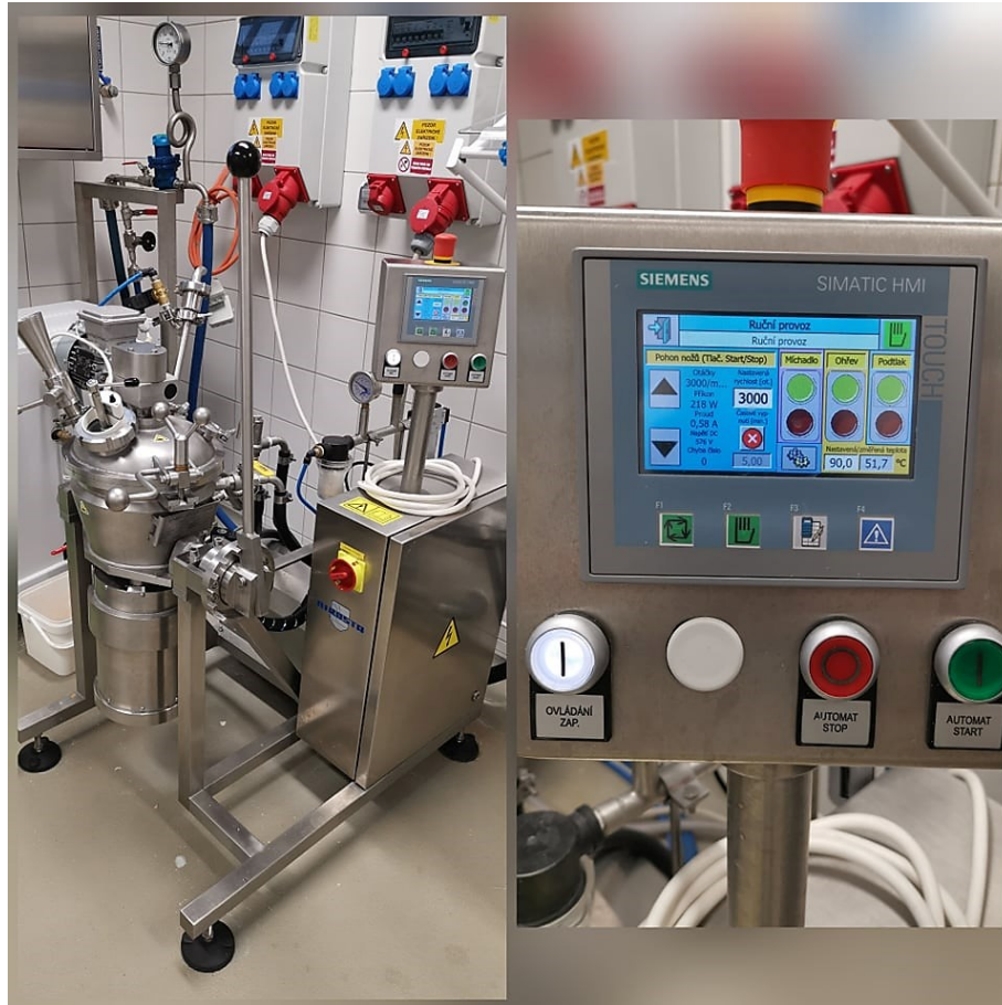
Obrázek 5: Tavička Niromix s řídicí jednotkou, jež byla použita pro výrobu modelových vzorků tavených sýrů (Šantová, 2022)
