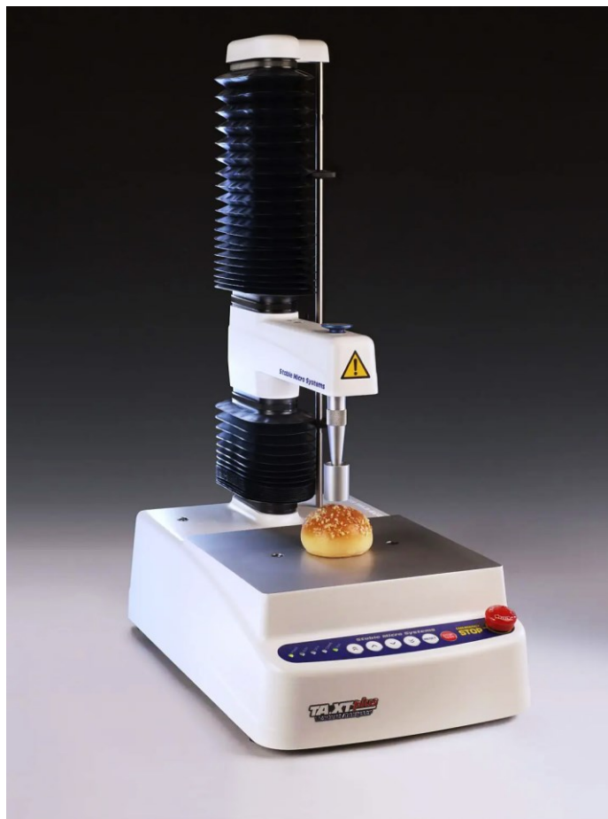
Obrázek 12: Texturometr TA-XTplus využívaný pro analýzu modelových vzorků tavených sýrů (3)
