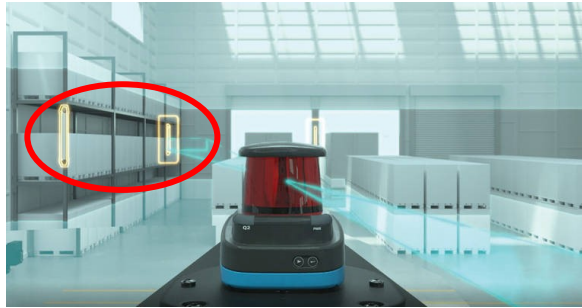
Obrázek 31 Navigace referenčními body (Toyota Material Handling, ©2022)
