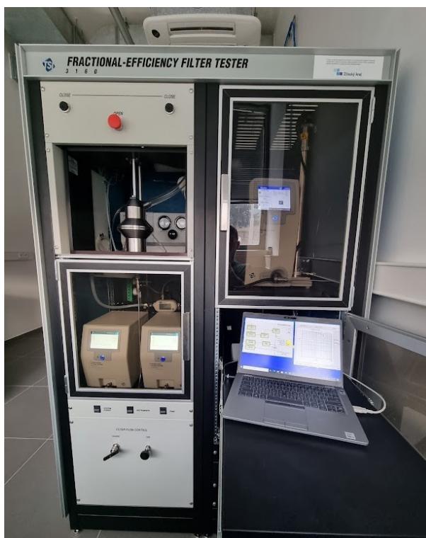
Obrázek 19: Příklad přístroje na měření filtračních vlastností
