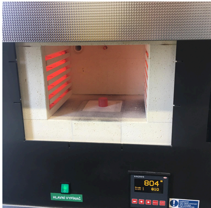
Obrázek 36. Ohřátý vzorek na kalici teplotu před vyjmutím z pece a následným ochlazením ve vodě nebo v oleji
