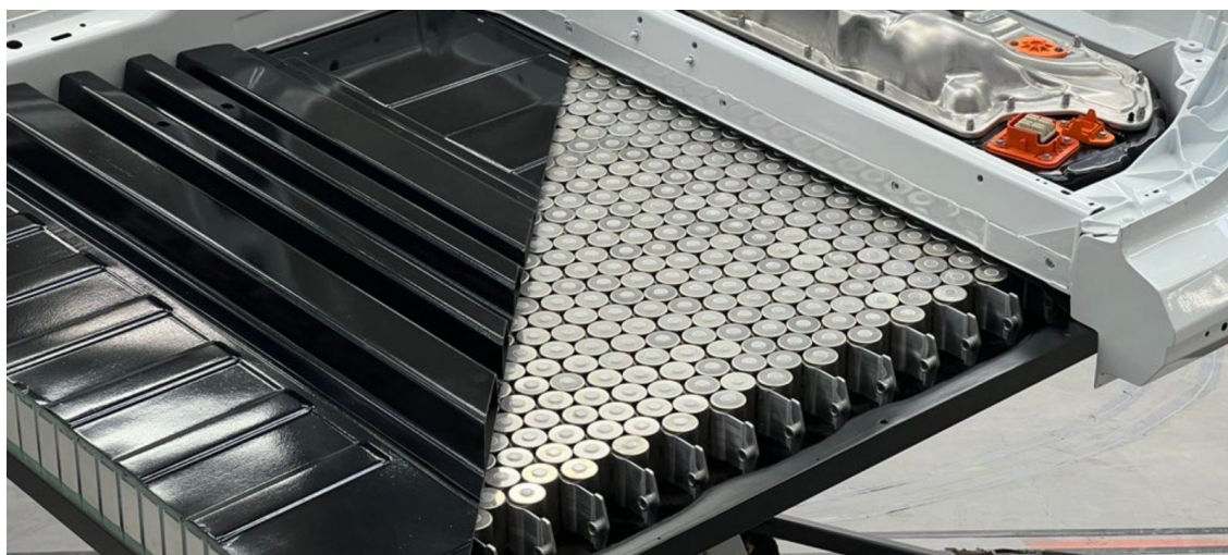
Obr. 29. Tesla bateriový box (zdroj: electrek.co)
